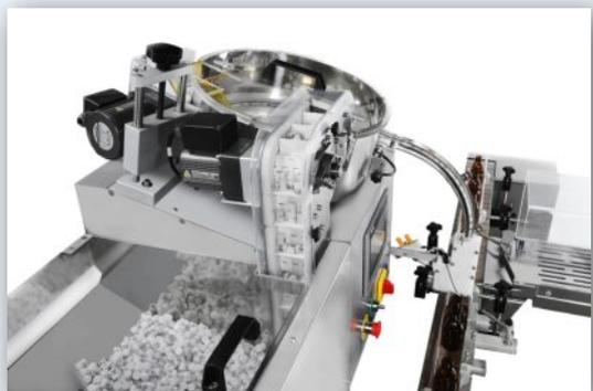
大容量顆粒乾燥劑料斗可供長時間送料，搭配上掀式透明外罩方便操作人員檢視料斗內乾燥劑剩餘數量及送料狀況，並可易於補料。
