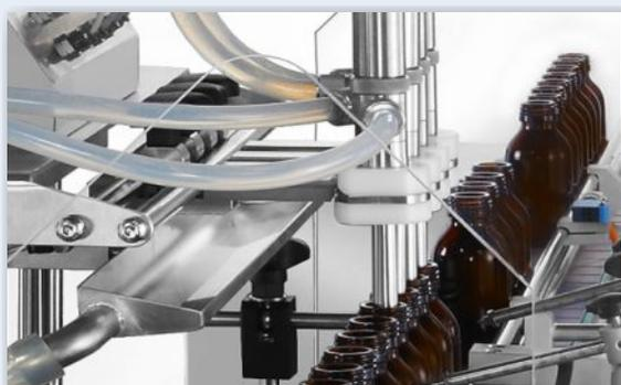
氣閘式充填嘴與防滴漏盤設計：氣閘式充填嘴建議使用於低黏性液體。
