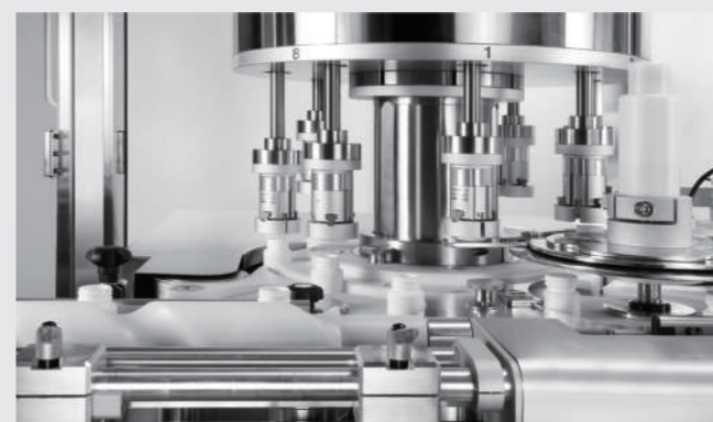
· 旋蓋頭的升降和旋轉，採用先進的Linmot線性馬達和伺服馬達驅動。
